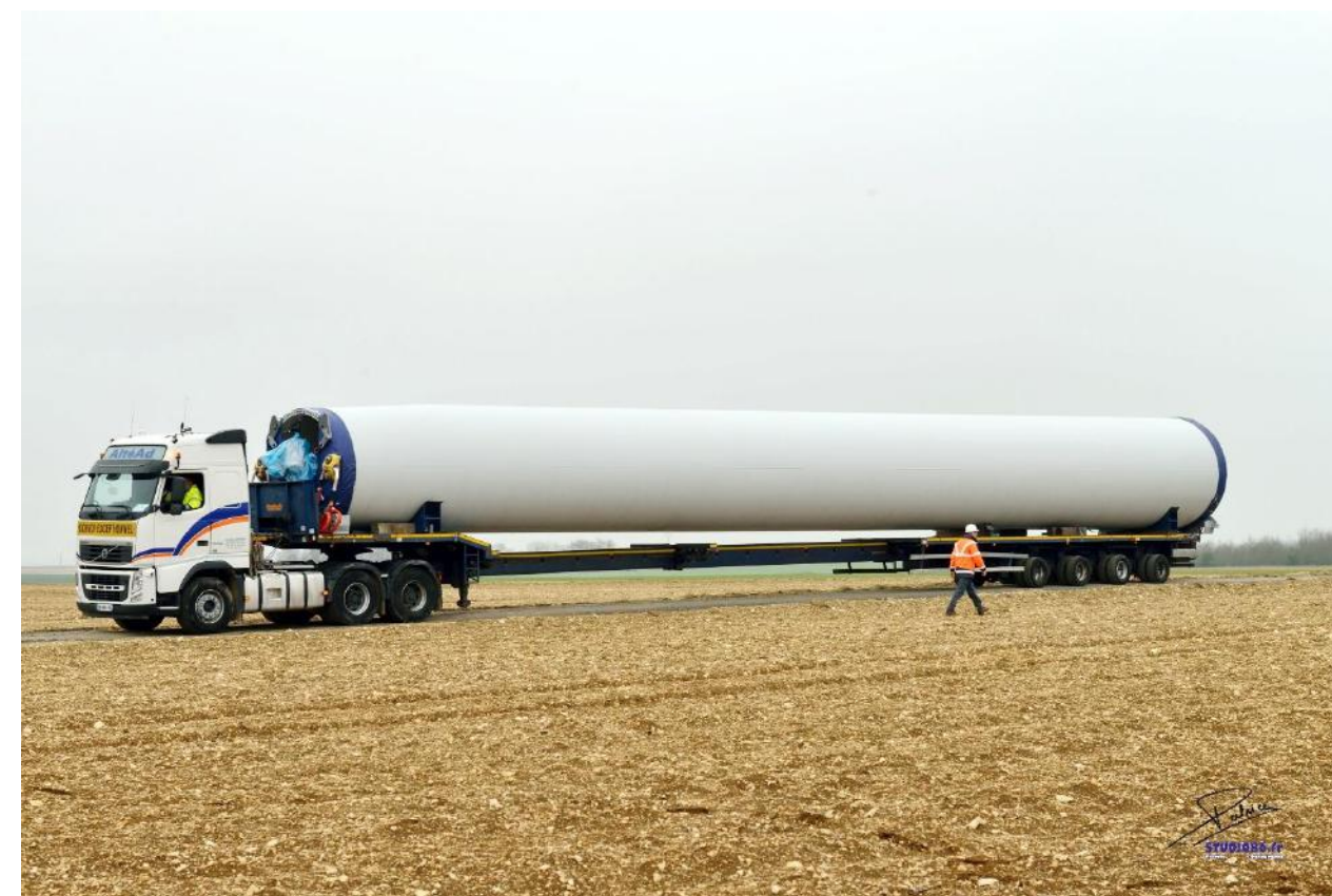
Figure 289 : Exemples de transport des éoliennes en convoi exceptionnel
